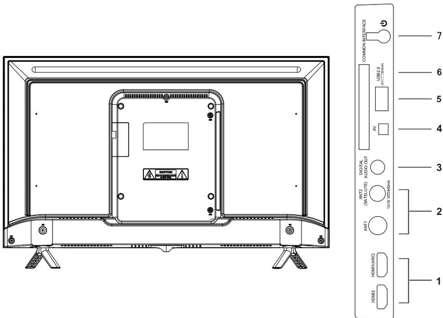
1. HDMI: Разъемы HDMI (Разъем HDMI1 поддерживает функцию ARC).
